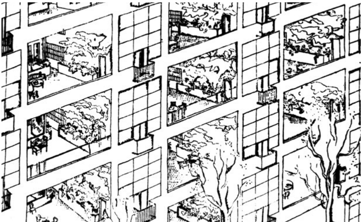
Il. 80. Fragment elewacji bloku mieszkalnego z Miasta dla trzech milionów mieszkańców . Na każdym podwójnym piętrze ogród-weranda
